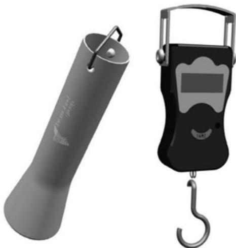
*Figura 6.7 - Ej. equipo para determinar el peso específico*
