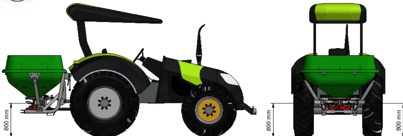
*Figura 5.2 - Ej. de colocación de la máquina en posición de trabajo.*
