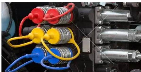
*Figura 5.6 - Válvula de acoplamiento rápido Ej. tractor*
